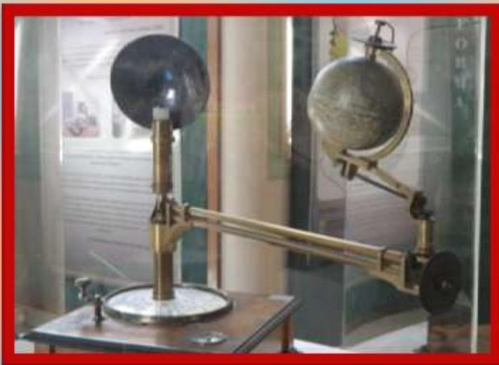
El telurio es un modelo mecánico del sistema solar que ilustra las posiciones relativas y los movimientos de los planetas y las lunas de acuerdo con el modelo heliocéntrico. Hay referencia de su uso en la antigua Grecia.
